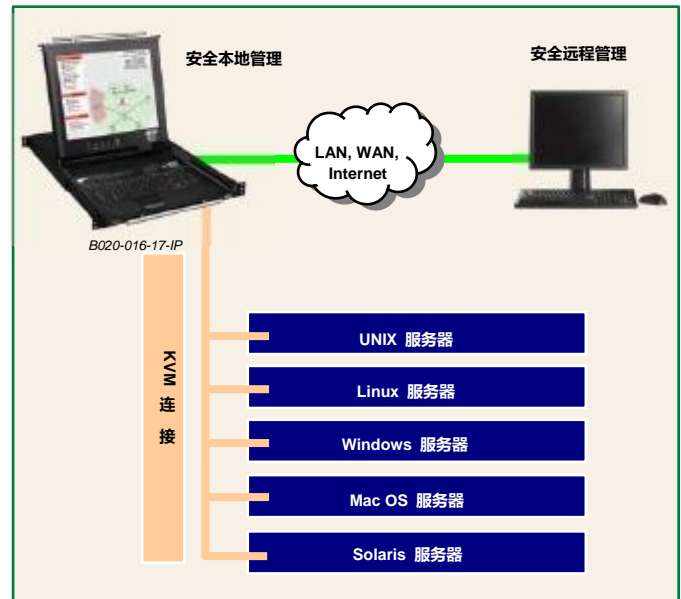
控制台KVM交换机具有内置的IP远程访问功能，允许您通过本地网络或互联网访问所连接的服务器。
