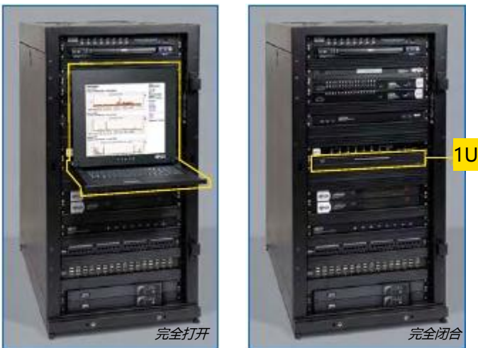
机架控制台可以像笔记本一样折叠并可推入 1U 机架抽屉。
